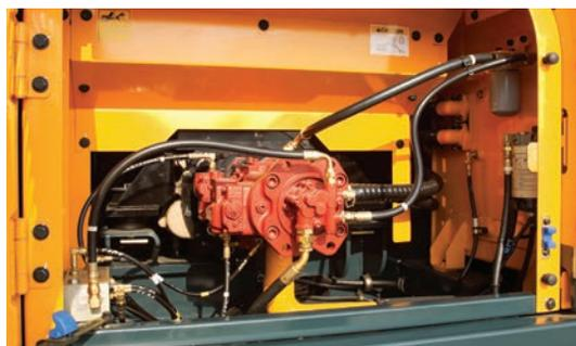
Для достижения оптимальной точности компания Hyundai переработала конструкцию гидравлической системы, обеспечив оператора возможностями сверхточного касания и улучшенной управляемости. Улучшенное управление подачей насоса уменьшает подачу, когда органы управления не используются, что позволяет свести к минимуму расход топлива.
