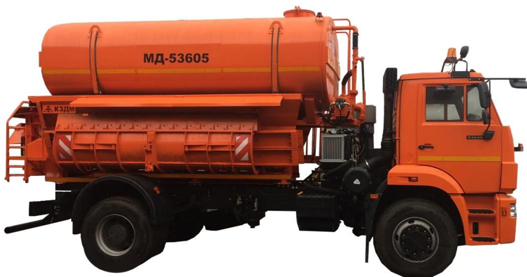
В состав оборудования входят: оборудование для распределения сыпучих ПГМ, поливомоечное оборудование, передний отвал (поворотный, скоростной, комбинированный и их модификации), щеточное оборудование (передняя, средняя и задняя цилиндрические щетки), высоконапорная мойка, система увлажнения ПГМ, мойка элементов пути.
